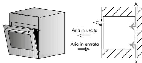
**Attenzione:** per garantire una buona ventilazione la nicchia deve essere provvista di un passaggio d'aria, posizione A e B compresa tra ≥80 e ≤850 cm<sup>2</sup>
