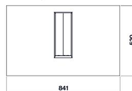
Dimensioni foro per installazione in appoggio
