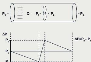
Comportamento del flusso con motore installato in cappa.
