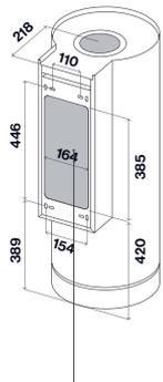
Uscita posteriore: rimuovere il tampone 385x164 mm.
