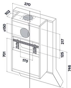
Uscita superiore: rimuovere il tampono 165x165 mm.
