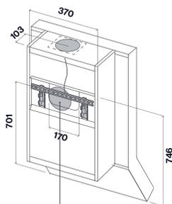
Uscita posteriore: rimuovere il tampono 170x125 mm.
