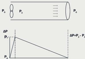
Comportamento del flusso con motore remoto installato in posizione finale.
