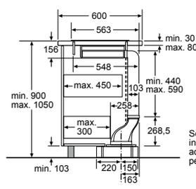
Se si utilizzano 2 unità di ventilazione in combinazione con la modalità di espulsione accertarsi che ci sia uno spazio sufficiente per il condotto per l'espulsione dell'aria.
