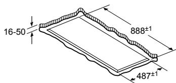
Non montare direttamente nel pannello di cartongesso o in materiali da costruzione leggeri simili del controsoffitto. È necessaria un'adeguata sottostruttura che sia fissata saldamente nella copertura in calcestruzzo.
