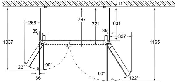
Vasca di raffreddamento completamente estraibile con angolo d'apertura anta di 122°
