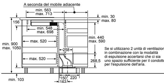
Se si utilizzano 2 unità di ventilazione in combinazione con la modalità di espulsione accertarsi che ci sia uno spazio sufficiente per il condotto per l'espulsione dell'aria.
