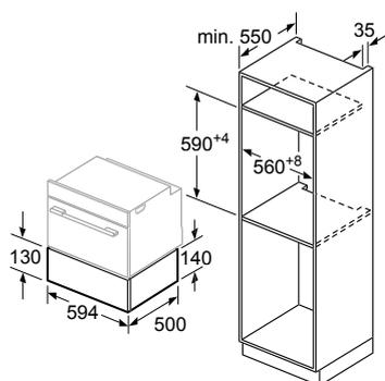
Sopra uno scaldavivande possono essere installati forni compatti con un'altezza apparecchio di 455 mm.
