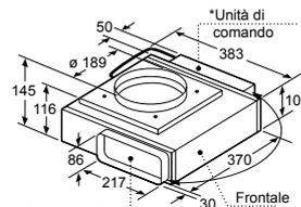
\*L'uscita dell'aria e l'unità di comando sono intercambiabili a vicenda. In caso di necessità l'unità di comando può essere fissato alla parete del mobile.
