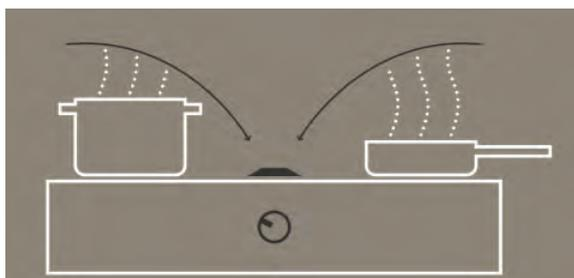
L'aspiratore da piano cottura BORA **aspira verso il basso** con una velocità di circa 4 metri al secondo. **(4 m/s)**
