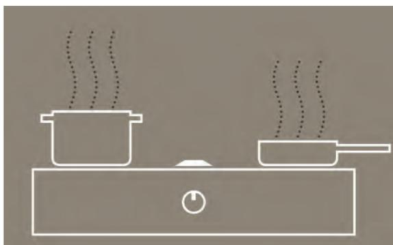
I vapori di cottura **salgono verso l'alto** ad una velocità massima di un metro al secondo. **(1 m/s)**
