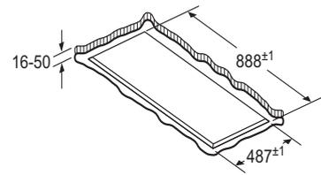
Non montare direttamente nel pannello di cartongesso o in materiali da costruzione leggeri simili del controsoffitto. È necessaria un'adeguata sottostruttura che sia fissata saldamente nella copertura in calcestruzzo.
