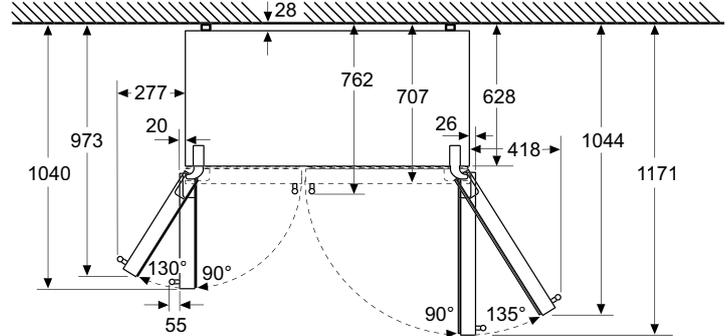
Con un angolo d'apertura anta di 135° i cassetti di raffreddamento possono essere estratti completamente
