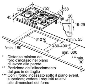
Per il montaggio a filo della superficie
