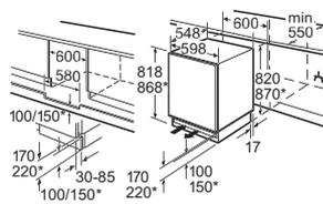
Spazio per il collegamento elettrico a destra o a sinistra dell'apparecchio. Aerazione nello zoccolo.
