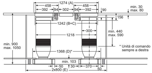
**Disegni tecnici di montaggio**
