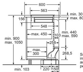
Se si utilizzano 2 unità di ventilazione in combinazione con la modalità di espulsione accertarsi che ci sia uno spazio sufficiente per il condotto per l'espulsione dell'aria.
